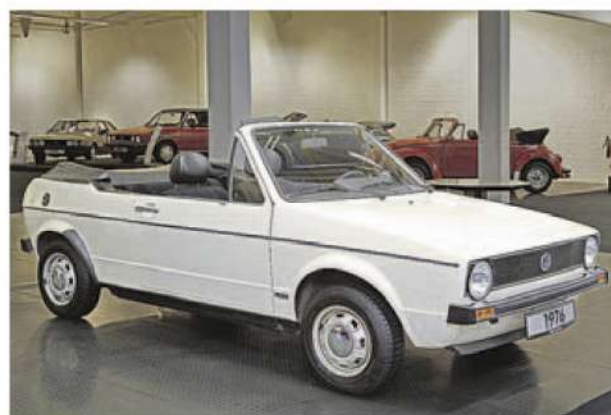
PROTOTIPO A1C Único prototipo que existe sin arco de seguridad, fue presentado a la fábrica Volkswagen en 1977 pero fue rechazado ya que carecía del citado elemento antivuelco. Una nueva filosofía en cuanto a seguridad automotriz que había llegado para quedarse.
