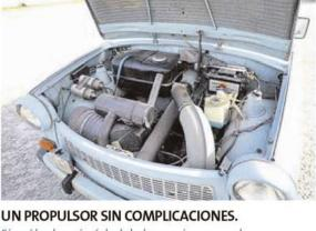
Sin válvulas, sin árbol de levas, sin correa de distribución, sin bombas de agua ni aceite y sin radiador. Este bicilíndrico resultaba suficiente, gracias en parte al bajo peso de conjunto, para mover con soltura el Trabant. Las emisiones eran su talón de Aquiles ya en los años 80.
