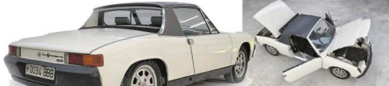
**FUNDACIONALIDAD.** La línea del 914 supuso un año de modernidad además de versatilidad. El motor colocado justo antes del eje traseño a diferencia del 911, le concedía espacio para un segundo maletero. Una capacidad de carga sorprendente para este tipo de vehículos.
