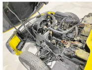
GRAN CAPO. La apertura en una sola pieza del capó y los pasos de rueda, facilitaba mucho las labores mecánicas.
